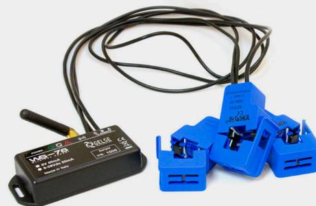
**Sensore WS-78** Wireless a 1-2-3 pinze, per la gestione della potenza di ricarica
